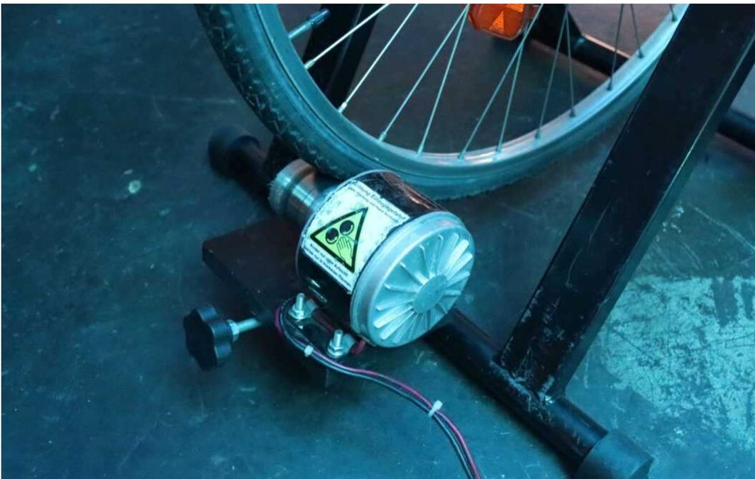
Der Stromgenerator am Hinterrad. Foto: ari
